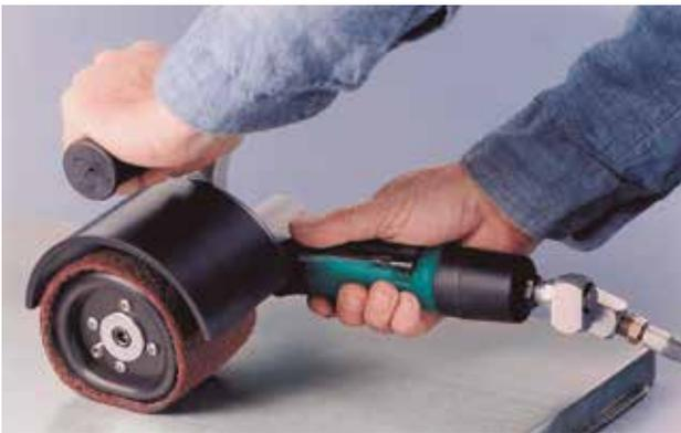
Instalados em lixadeiras e retificas portáteis, são indicados para operações de acabamento superficial. A agressividade do lixamento pode ser controlada de duas maneiras: ajustando a pressão de ar do pneu e escolhendo o abrasivo correto para o acabamento pretendido.
