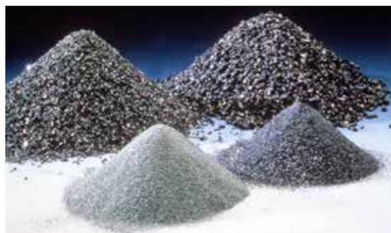
Para jateamento, polimento de lentes oftálmicas, mármore, granito e outros materiais não ferrosos, como metais e ligas metálicas.
