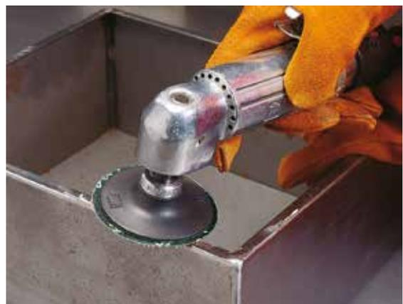
Suporte para fixação de discos abrasivos do Sistema Roloc 3M – encaixe rápido com ¼" de volta, manualmente sem uso de ferramentas.
